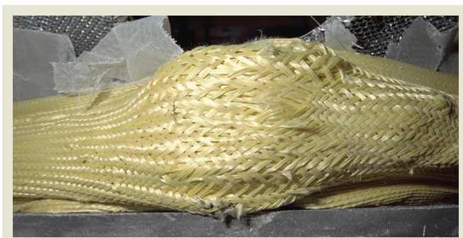
Sopra: Prova impatto balistico su kevlar® (fibra para-aramidica) intrecciato, NASA/Glenn Research Center. A fianco: Fibra di kevlar®.
